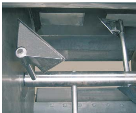
Mischerinnenraum mit Luftschlitzen und doppelter Bodenklappe
