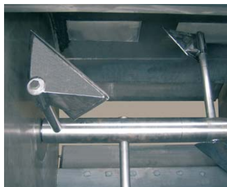
Внутренняя камера смесителя с воздушными щелями и двойным донным клапаном
